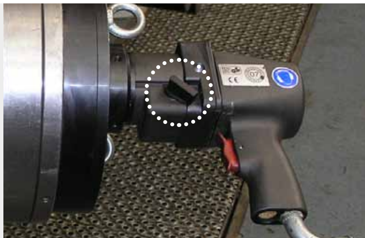
alkitronic® CLS2 , atornillador de 2 velocidades. Palanca de cambio a marcha rápida o de potencia.
