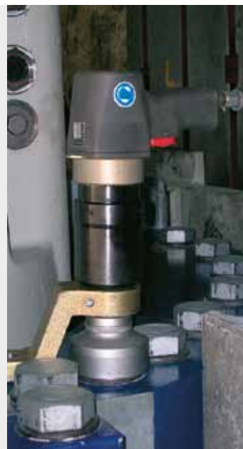
alkitronic® CLD atornilladores en el trabajo (fotos a la derecha). Uniones roscadas en una brida con tuercas así como en un motor.
