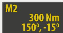
Procedimiento de par/ángulo para conexiones de empinado de alta calidad. Muestra ejemplo de par previo, ángulo y ángulo de afloje.
